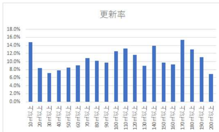
図3-3-1 建築面積別更新率(住宅用途のみ)
